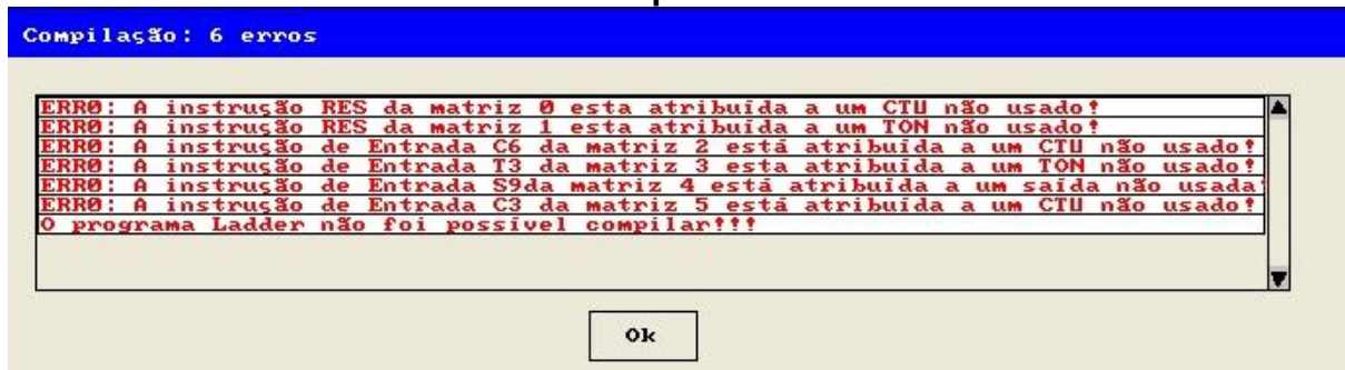
FIGURA 36 – Exemplo de erros sintáticos
